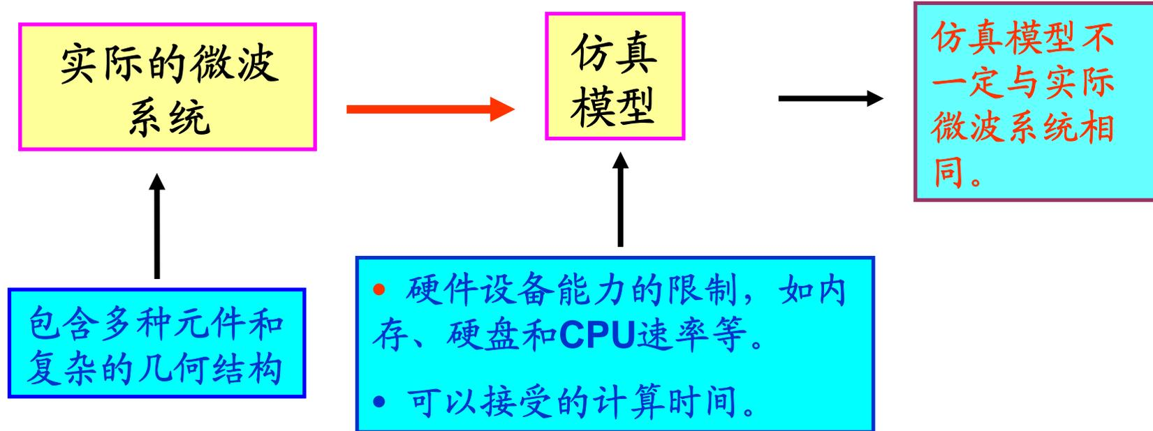
通常，电磁问题实际的物理模型都比较复杂。基于目前的计算机硬件和计算机软件的水平，我们还不可能把实际的物理模型作为仿真模型进行计算。因此，建立仿真模型首先就要学会分解、简化物理模型。在保证一定计算精度的条件下，使仿真模型尽量简单。
